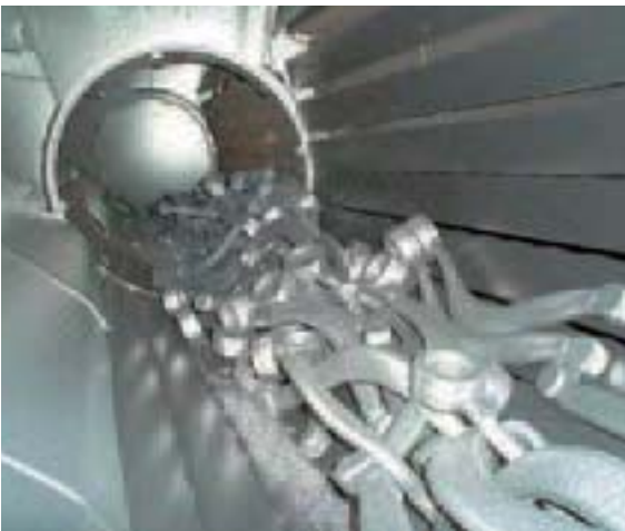
Transportsystem mit Muldenstäben aus Manganstahl
