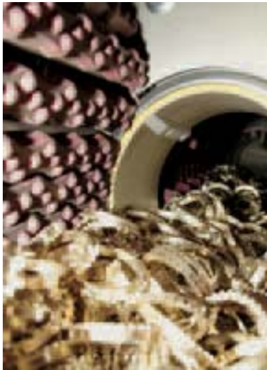
Optimale Umwälzung der Werkstücke in der Strahlmulde
