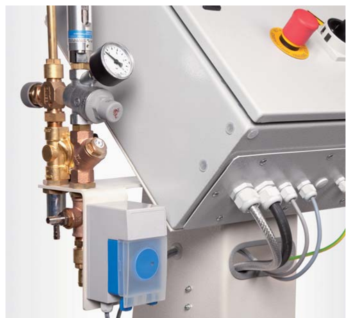
Dosierstation zum stufenlosen Einstellen des Spülmittels
