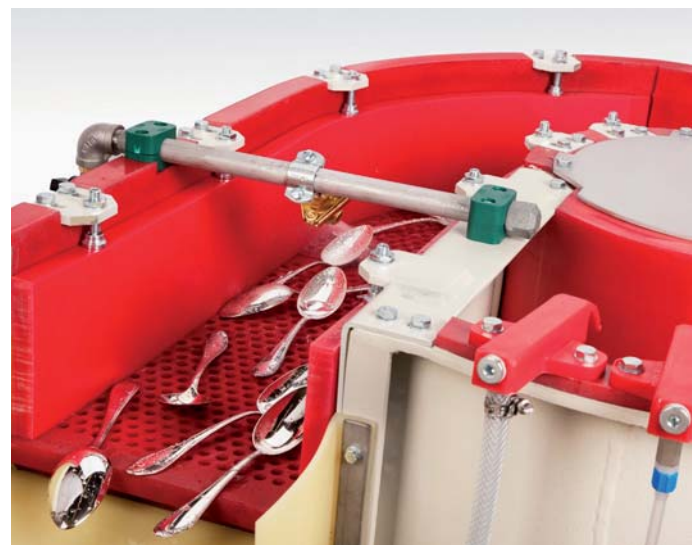
Klarspülzone einer BRA-Anlage
