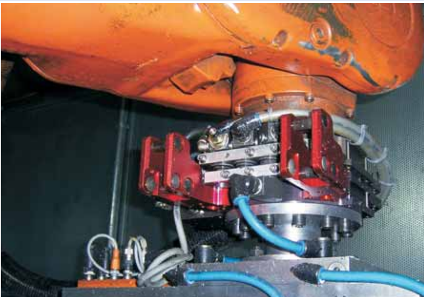
Bearbeitungsapplikation an einer Spannvorrichtung für Gusswerkstücke Application at a clamping device of cast pieces
