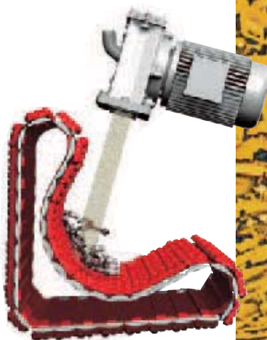
Geringer Turbinenabstand zu dem Strahlgut
