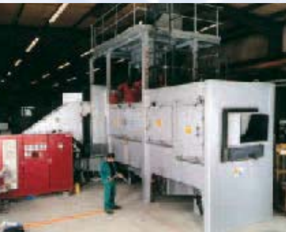
Transportsystem mit Muldenstäben aus Manganstahl
