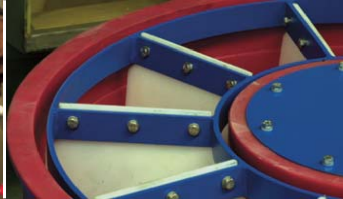
Trennschieber (optional) zur Bearbeitung empfindlicher Werkstücke.
