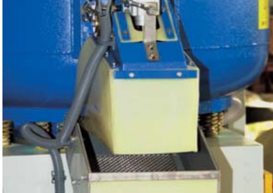
Pneumatischer Behälterauslauf (optional). Der großflächig dimensionierte PN-Auslauf erlaubt Kompletentleerung des Behälters.
