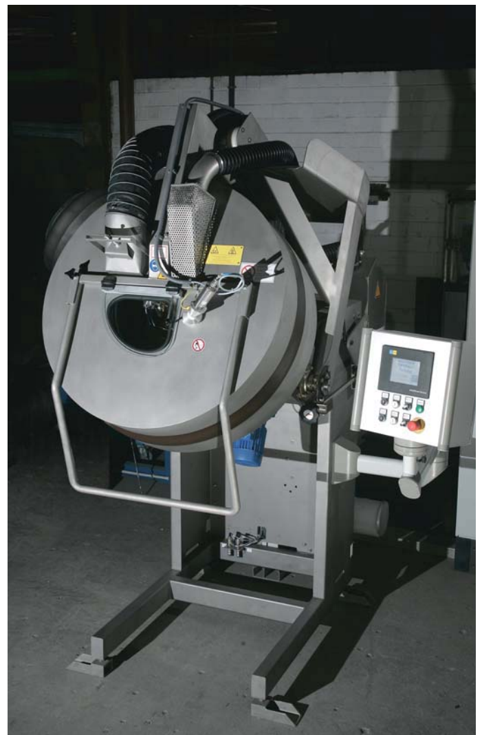
R 90 mit IR-Sensor und Bedienpult
