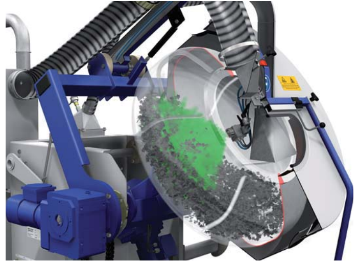
Beschichtungsvorgang in einem Rotamaten
