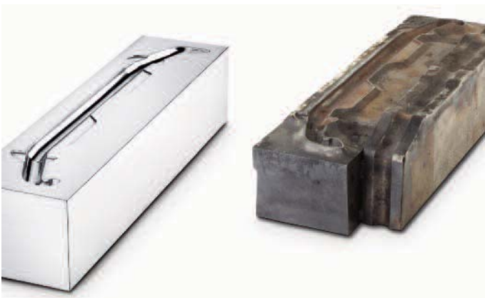
Gereinigte und aufbereitete Schmiedeform
